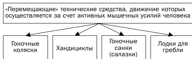
Рис. 3. Классы «перемещающих» технических средств, движущихся за счет активных мышечных усилий человека, выделенных в зависимости от места приложения человеком усилий.
