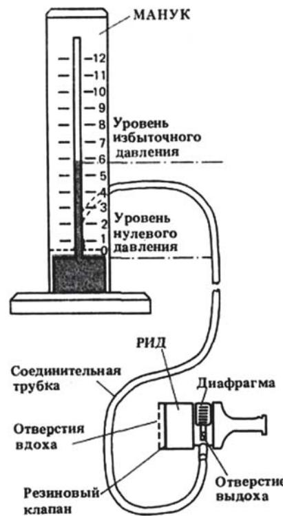
Рис. Манометрический указатель (МАНУК) в комплекте с регулятором дыхания (РИД).
