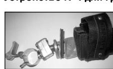
**Состав устройства №4:** манжета; фиксирующая лента; упорная рама устройства; шарнирный шариковый механизм; разрезной хомут; регулировочный барашек. **Устройство №4 крепится** к культе предплечья при помощи манжеты и фиксирующей ленты, разрезной хомут надевается на цевьё весла или цевьё от тренажера и затягивается барашком.
